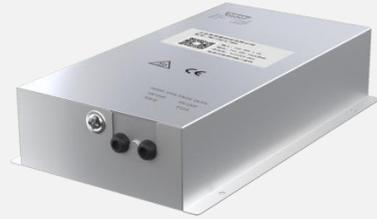
泰思曼 TMI6100PN1-15 是一款高性能的 DC-DC 转换器，能够良好地调节输出。该转换器提供了浮地 1kV @ 15mA 输出，工作范围为 300V-1000V。正极性或负极性输出，且隔离，非常适合作为质谱分析中的探测器使用，如：电子倍增器 (EM)、微通道板探测器 (MCP) 和通道电子倍增器。该模块采用屏蔽的金属外壳封装，通过两个固定的电缆提供高压输出。此外，该电源还具备远程电压编程和电压监测功能，并且可以通过 TTL 兼容的使能信号实现高压输出控制。
