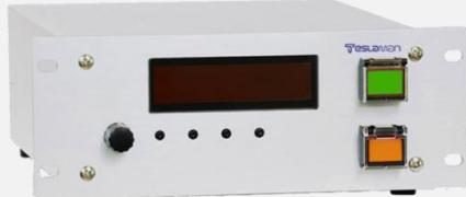
泰思曼 TESC7080 系列高压电源专为静电卡盘的应用而设计，能够在 10ms 内输出精确的电压，并在 1s 内切换极性，从而为半导体制程过程提供保护。它具有可逆的对地参考输出极性，也可以输出浮地双极电压，并有相应的浮地接口。它还有完善的故障诊断和状态监测功能，可以将数据传送到用户界面。它的封装设计紧凑轻便，可 OEM。
